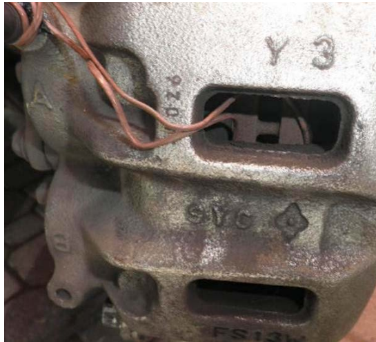
איור 7 – התקנת צמדים תרמיים, בלם קדמי.
