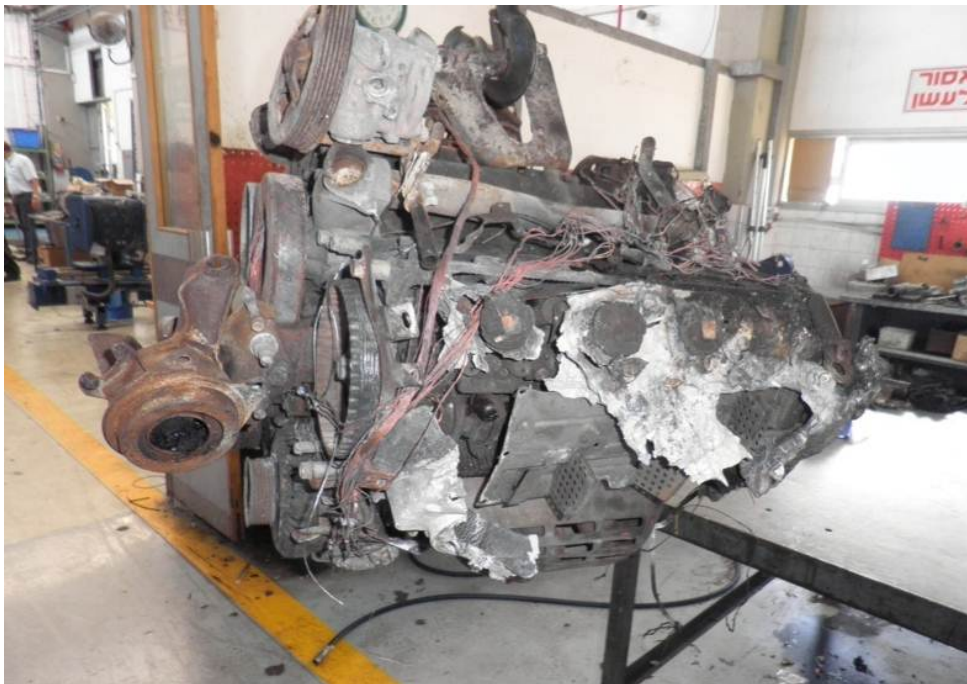
איור 15 - מנוע הרכב לפני פירוקו
