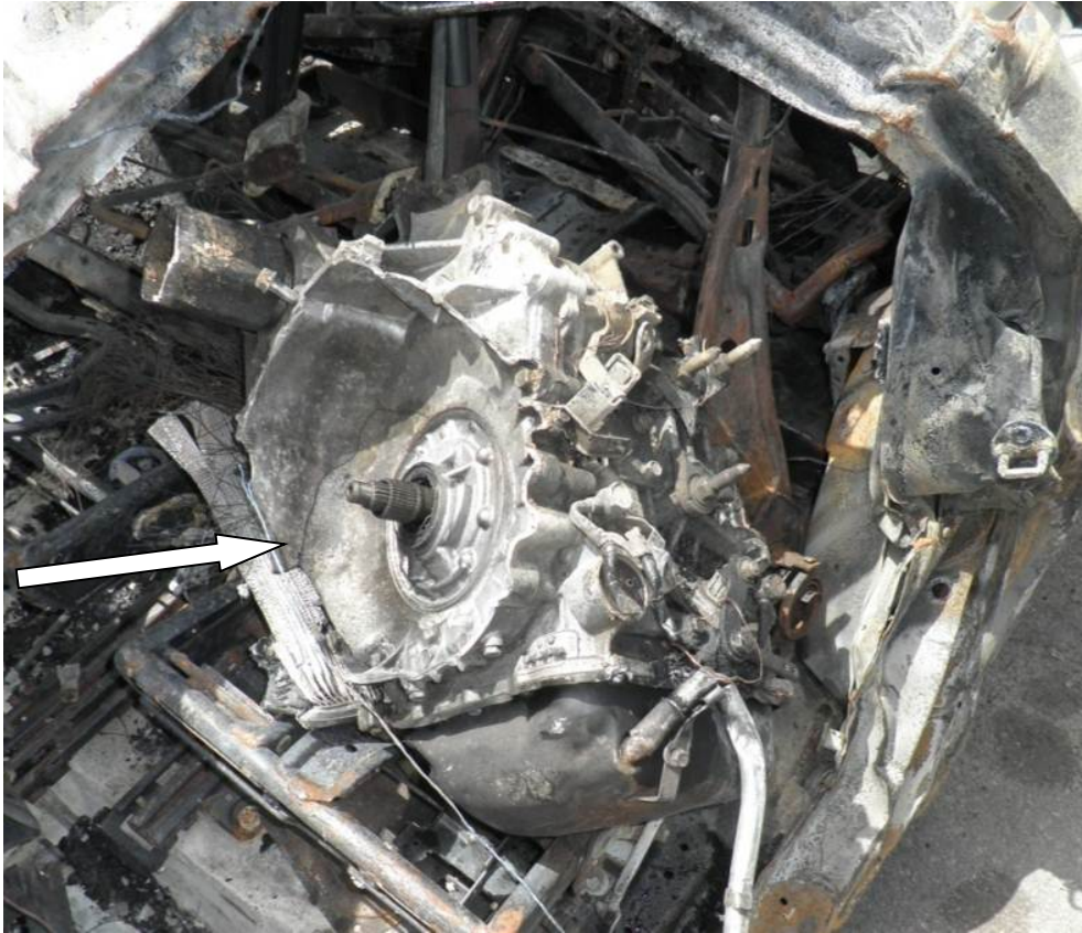
איור 22 - שברים בבית המצמד המתחבר למנוע (כתוצאה מהתאונה).
