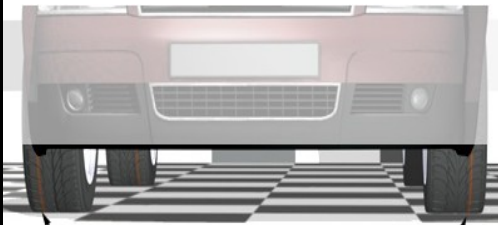
כוון סמני סטיית גלגול הצמיגים הקדמיים מנוגדים, הרכב יתמיד במסלולו.
