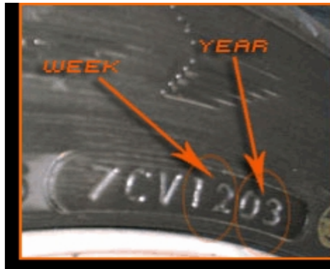
תאריך הייצור על גבי הצמיג 1203 (שבוע 12 שנת 2003)
